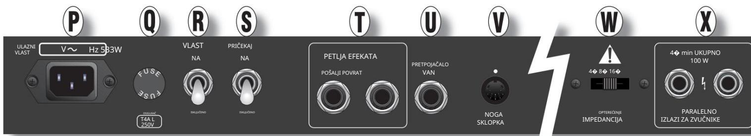
P . **ULAZ NAPAJANJA**—Priklučite priloženi kabel za napajanje u skladu s naponom i frekvencijom navedenim na stražnjoj ploči pojačala.
